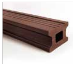
バイタル根太 材質: 木材・プラスチック再生複合材 規格: 40×50×2400mm 梱包: 4本/束(9.6m/束)
